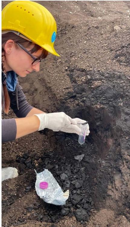
Die Probenahme erfolgte mit sterilisierten Löffelspateln in sterilisierte Falcon-Röhrchen. Es erfolgten keine weiteren Vorbehandlungen.
